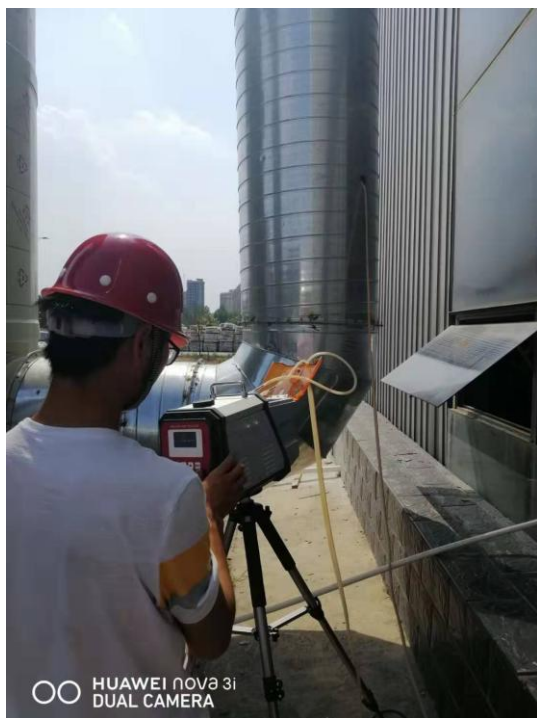
(水帘除尘+低温等离子+活性炭吸附设备进、出口采样图)
